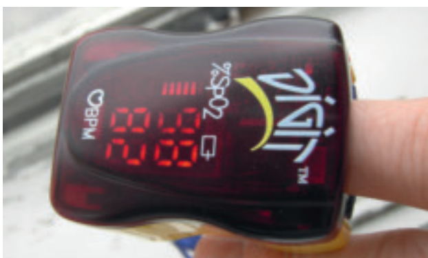
Abb. 1. Modernes digitales Transmissionspulsoxymeter. Links S p O 2 und Kapillarpuls (BPM), rechts Absorptionsspektren: O 2 Hb und desoxyHb (HHb) bei den Wellenlängen 660 nm (rot) und 940 nm (infrarot)
